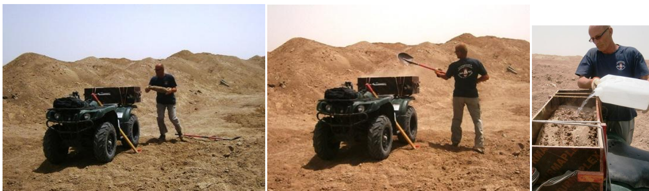
Transport de l'obus dans une caisse à sable mouillé vers un site de stockage temporaire avant destruction
