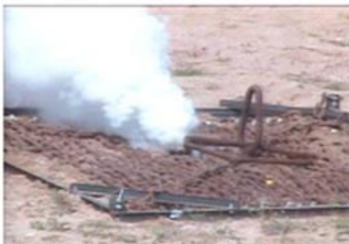
Une fumée blanche... sous l'impact de DEMICHAIN, la mine d'exercice émet de la fumée. Une mine réelle aurait explosé.
