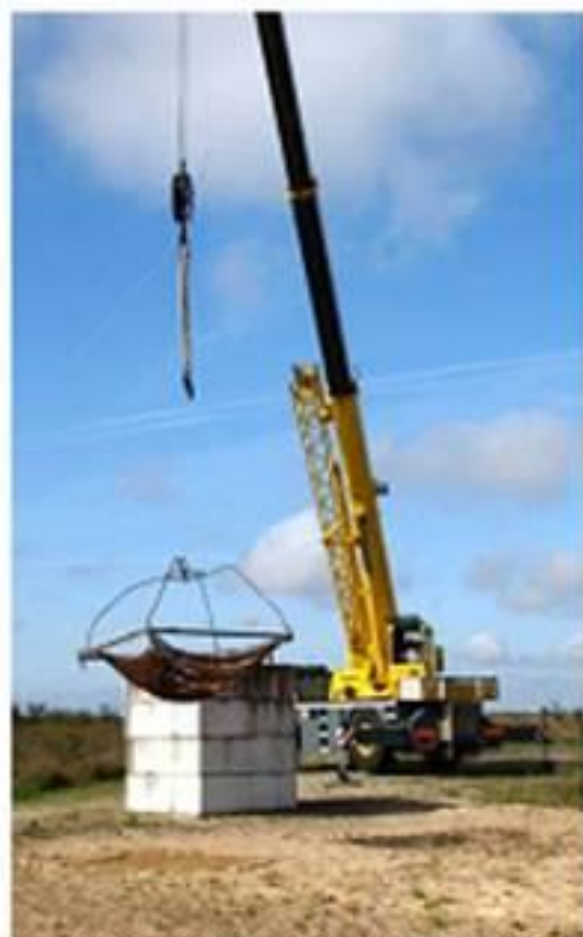
DEMICHAIN en chute libre à l'ETBS va heurter le sable dans lequel est enfouie une mine d'exercice
